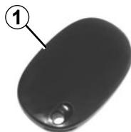
Per i veicoli equipaggiati con l'emettitore-ricevitore **1**, quest'ultimo, quando è presente in una delle zone di accesso **2**, permette, oltre alle funzionalità del telecomando, di effettuare il bloccaggio/sbloccaggio senza necessità di agire sul telecomando.
