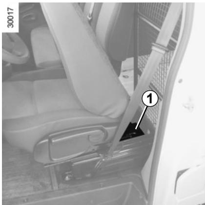
A seconda del veicolo, in caso di foratura, utilizzate il kit di gonfiaggio **1** situato sotto il sedile del conducente.
