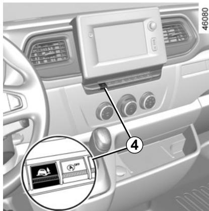
Premere il tasto **4**: sul quadro della strumentazione viene visualizzato il messaggio «Modo Off Road Attivato».
