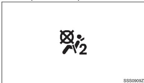
La spia di stato dell'airbag per passeggero anteriore si trova nel quadro strumenti.
