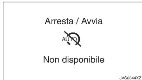
Se il motore si spegne tramite il sistema Stop/Start attivato e non si riaccende automaticamente, questo messaggio viene visualizzato.
