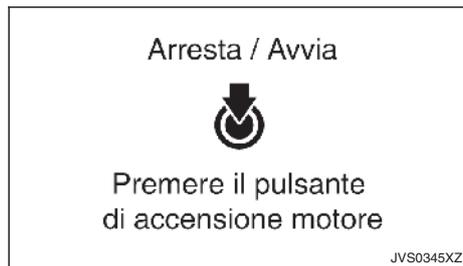
Queste informazioni vengono visualizzate e un segnale acustico viene emesso per ricordare al conducente di girare il contatto su OFF per evitare che si scarichi la batteria.
