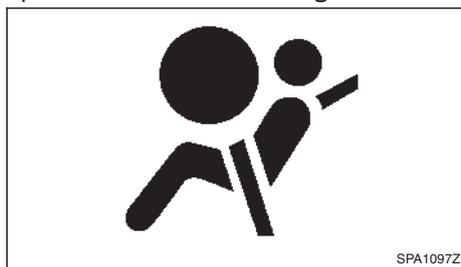
La spia di avvertimento SRS airbag, con la visualizzazione
