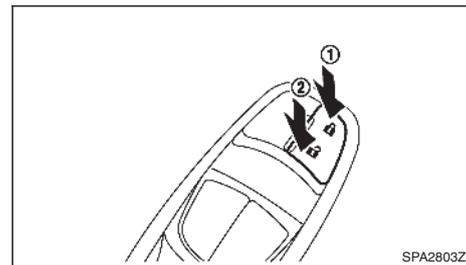
Per bloccare le porte, premere l'interruttore della chiusura centralizzata sulla posizione di bloccaggio ①.
