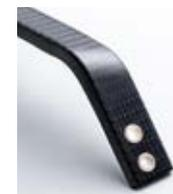
I pannelli interni delle portiere realizzati in alluminio pressofuso provvedono alla stabilità strutturale e in caso di collisione riducono la deformazione. L'alluminio pressofuso viene impiegato anche per gli alloggiamenti degli ammortizzatori anteriori e per le sospensioni anteriori. Per accrescere la solidità, la barra duomi delle sospensioni è realizzata in composito di carbonio leggero con struttura a nido d'ape in alluminio.
